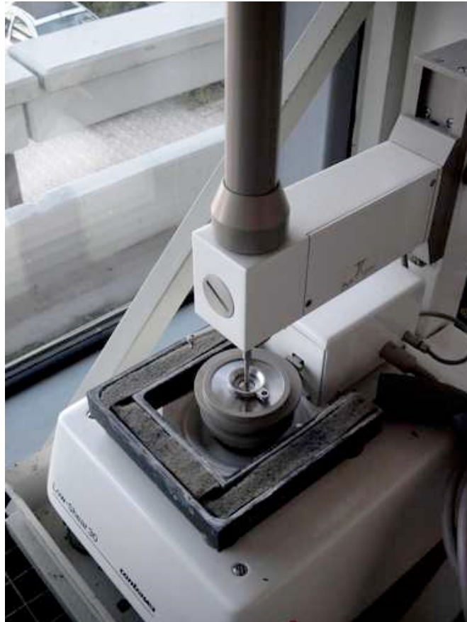
Abbildung 2.4: Diese Fotografie zeigt den besonderen Aufbau des verwendeten Viskosimeters. Deutlich zu erkennen ist der extra angebrachte Wasserkanal, in dem sich Schaumstoff befindet, das während der Messung mit Wasser getränkt ist. In Kombination mit einer Plexiglashaube, die den Probenbereich einschließlich diesem Wasserkanal abdeckt, wird so dafür gesorgt, dass die Luft über der Probe stets eine hohe Luftfeuchtigkeit besitzt und somit beim Erhöhen der Temperatur die Probe nicht austrocknet. Weiterhin kann man den Probentopf mit dem darin hängenden Pendel erkennen. In dem darüber foldenden größeren Aufbau befindet sich der Torsionsfaden.
