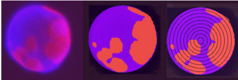
Abbildung 5.15: Das konfokale Bild eines Vesikels einer Mischung von 20 % DLPC und 80 % DPPC. Es wird im Kontrast verstärkt und Mikrodomänen werden als nicht vorhanden angenommen. Anschliessend werden die Projektionsflächen als Kreisringe eingezeichnet und deren Zusammensetzung ausgewertet (siehe Kap. 2.4).
