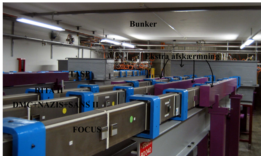
Figur 3.13: Neutronguides til de kolde neutronspreddningseksperimenter på PSI. Billedet er fra en bunker, hvor hver enkelt guide krummer for at frasortere højenerginetroner. Krumningen har typisk en radius på 2 km og kan derfor ikke ses på billedet, men man kan se afskærmningen beregnet til at absorbere de neutroner, der ikke bliver reflekteret med rundt. Hver guide er 12 cm høj og mellem 2 og 5 cm bred. De runde farvede mærkater angiver, hvilken kvalitet hver enkelt spejl er.
